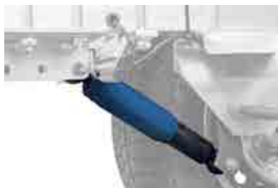
2 shock absorbers, Achsstoßdämpfer, amortisseurs, amortyzatory
